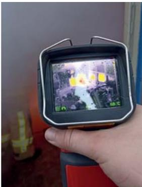
Der Löschaufbau zu Beginn - geschenkt. Die Basics zur Persönlichen Schutzausrüstung (PSA) - eine gute Wiederholung. Das Vorgehen und Einsatztaktik - essenziell wichtig! Schwerpunkt der Übung war der richtige Einsatz der Wärmebildkamera (WBK). Mittels der WBK lassen sich z.B. anhand der Temperatur der Türe schon taktische Schlüsse ziehen, noch bevor die Türe zum Brandraum geöffnet wird.
